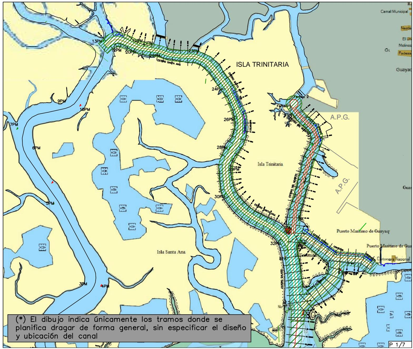
(\*) El dibujo indica únicamente los tramos donde se planifica dragar de forma general, sin especificar el diseño y ubicación del canal
